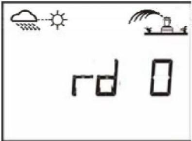
С помощью кнопок и Вы можете установить отмену полива от 1 до 15 дней. На экране появятся символы: и , а также количество дней через которое контроллер врнется к обычному режиму работы. Для отмены дождевой задержки необходимо уменьшить количество дней до 0.
